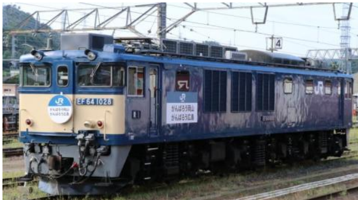
EF64形式直流電気機関車
